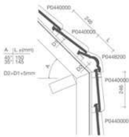
Lengtedoorsnede dak met gevel ter hoogte van knikpan
